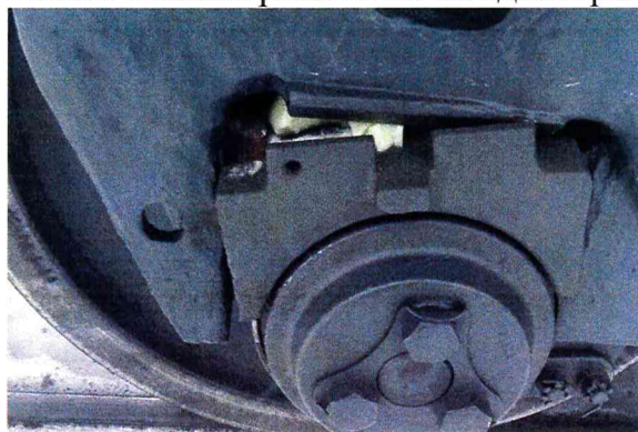
Рис.3г Неисправность полимерной вставки адаптера
