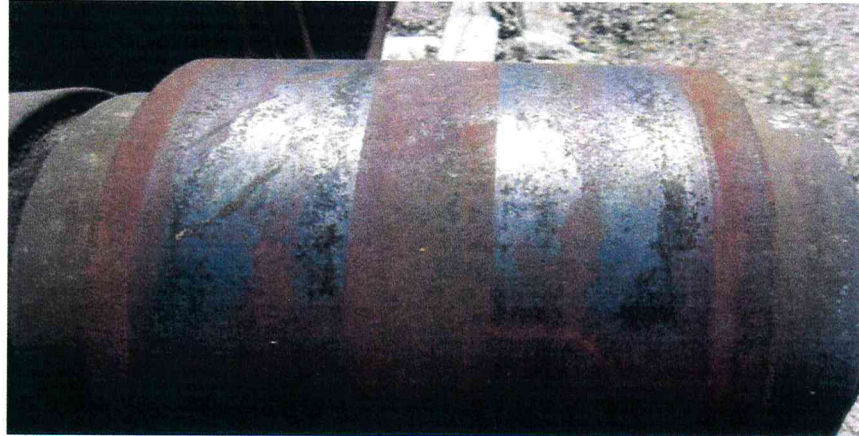
Рис. Г.4 Следы на наружном кольце подшипника, указывающие на правильную работу адаптера (симметрично расположенные полосы одинаковой ширины, не достигающие до края подшипника)
