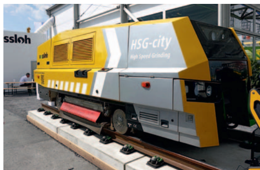
Скоростная рельсошлифовальная машина HSG-city для трамвайных линий и линий метрополитена
