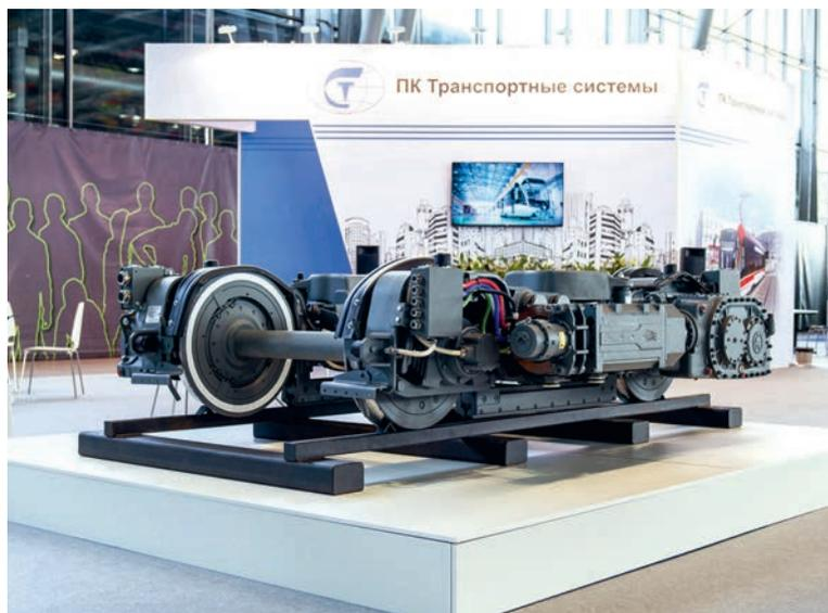
Рис. 2. Тележка ПК ТС для путей 1000 мм
