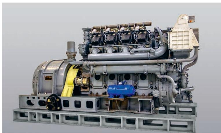
Газовый двигатель-генератор 9ГМГ для газотепловоза ТЭМ29
