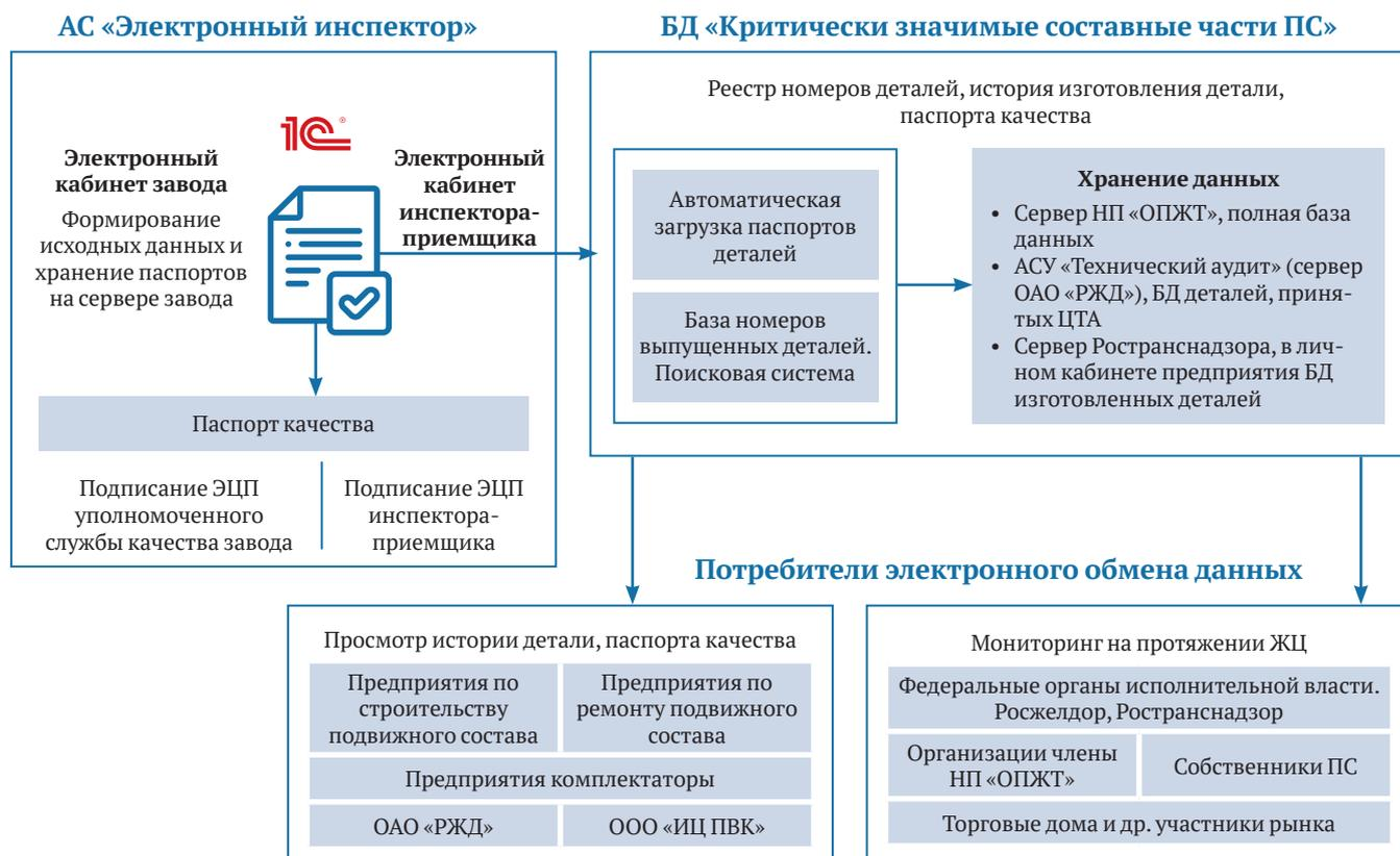
**Рис. 1.** Схема формирования базы данных АС «Электронный инспектор»
