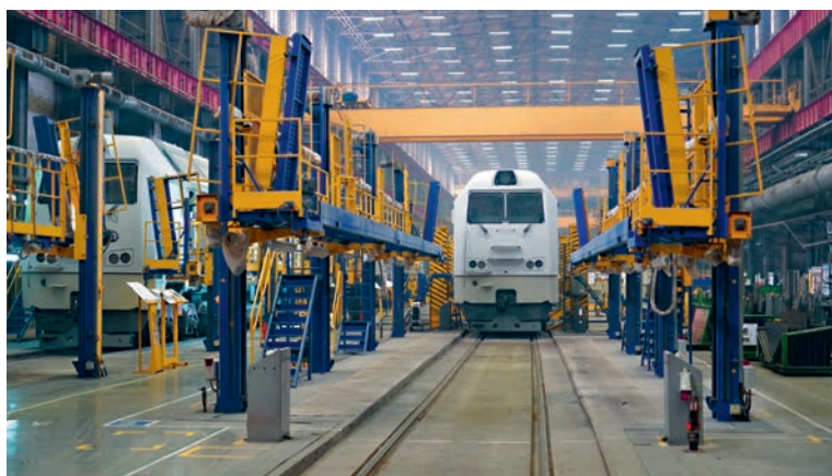
Эталонная линия по сборке тепловозов на Брянском машиностроительном заводе (входит в ТМХ)
