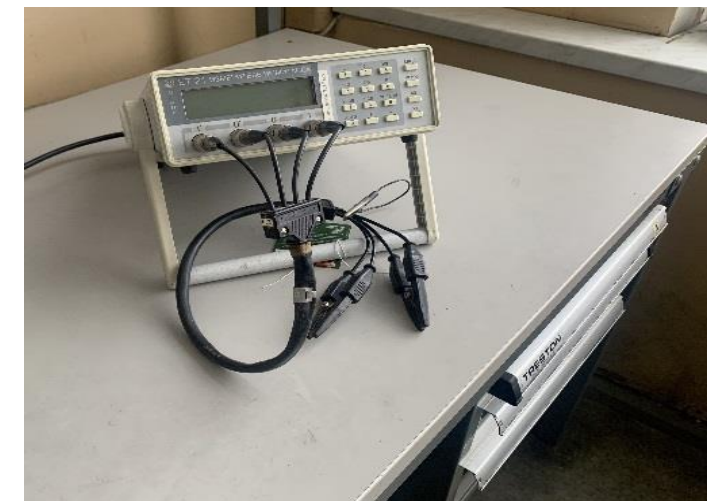
Прибор для проверки радиодеталей (измеритель имитанса)
