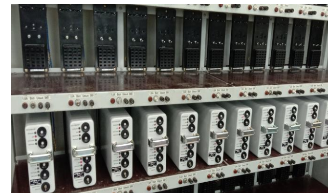
100% технологический прогон готовых изделий (48 часов)
