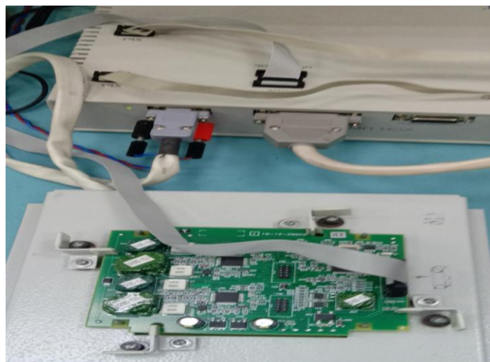
Входная проверка плат
