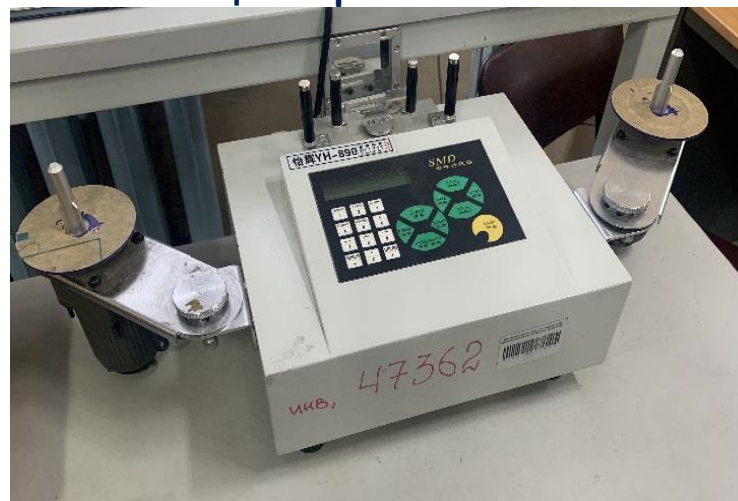
Автомат для контроля поставки SMD компонентов и их позиционирование в ленте
