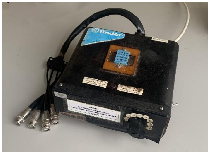
Установка проверки реле для электронных блоков
