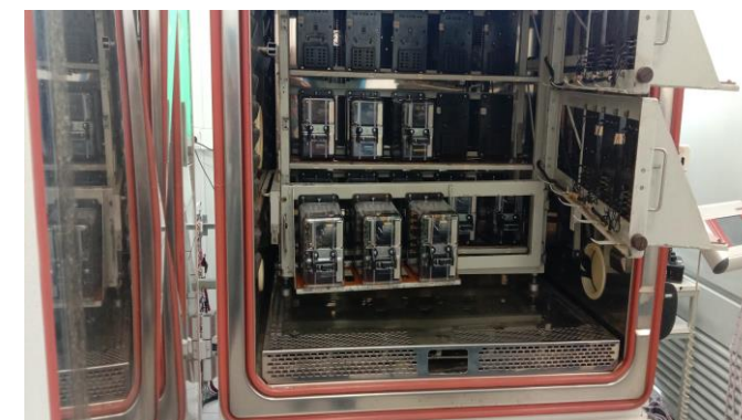
100% климатический прогон готовых изделий ТРЦ (24 часа; -45 +55 С)
